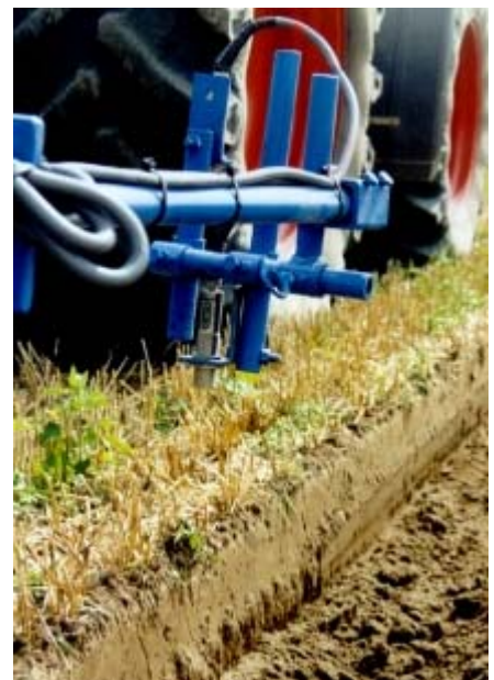
Abb. 3: Ultraschallsensoren am Rahmen eines Onland-Pfluges (Foto: Werkbild LEMKEN)
