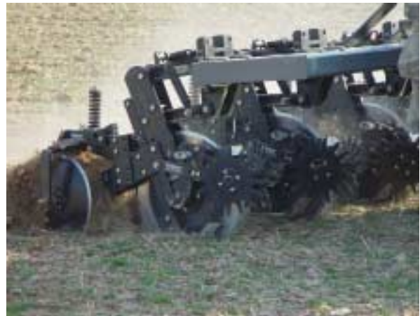
Abb. 7: Dammbildung auf zukünftiger Maisfläche
