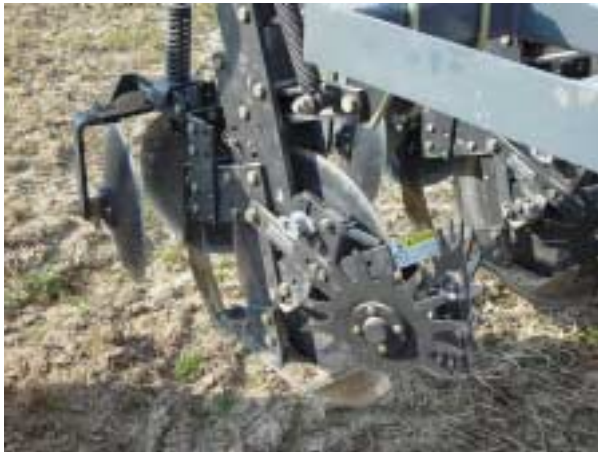
Abb. 6: Aggregat zur Dammbildung auf Maisflächen
