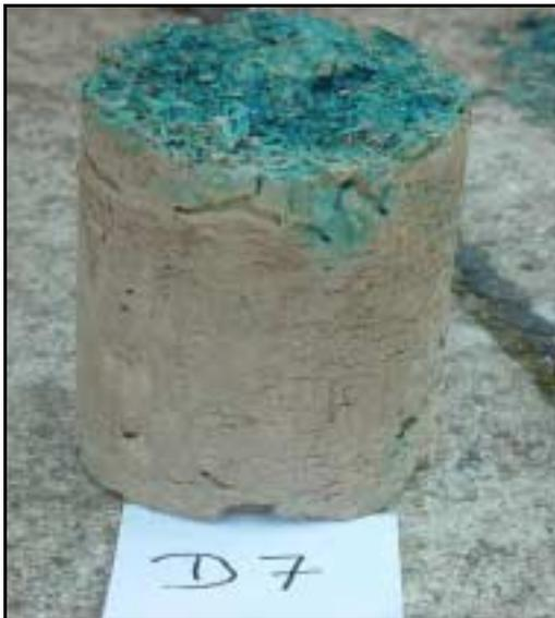
Abb. 28: Einfärbung der Bodenmatrix im Bereich einiger Makroporen (Direktsaat)
