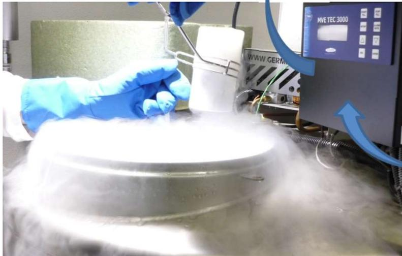
Langzeitlagerung in gasförmigem Stickstoff (-192°C)
