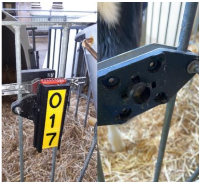
Abbildung 2: Smart-ID am Kälberauslauf (links) und defekte Smart-ID (rechts)
