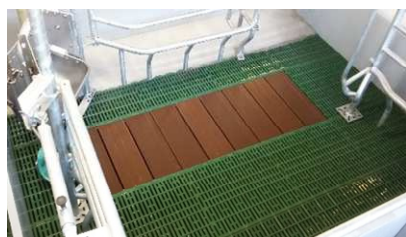
Keramik/Keramik und PVC Die 3 hinteren Platten wurden aufgrund hochgradiger Verschmutzung der Liegeflächen durch PVC Roste ersetzt
