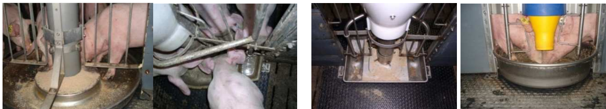
Abbildung 1 Verwendete Rohrbreiautomaten (von links nach rechts (Produktname in Klammern): Schauer: ( Ecomat ), Aco Funki: ( 3 in 1 ); Big Dutchman: ( Pig-Nic ); AP: ( AP Swing ),
