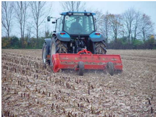
Abb. 2: Maisstrohzerkleinerung mit Mulcher
