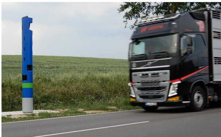
Mit der Kontrollsäule wird erfasst ob die Maut entrichtet wurde. (Foto: Vaupel)
