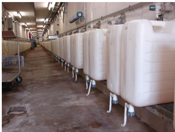
Abbildung 1: Schematischer Aufbau eines Gravitationslysimeters an der Lysimeterstation in Falkenberg nach Godlinski, 2005 (links) und Sickerwasserauffanganlage (rechts)
