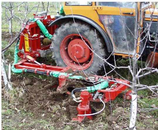
Abb. 5 (oben links): RADIUS NG im Zwischenachsanhbau mit Scheibenmulcher (Versuchsanbau)
