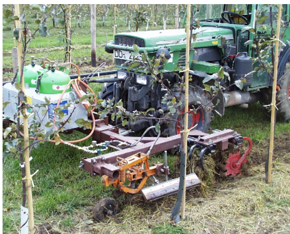
Abb. 3: Versuchsgerät mit Stabbrenner und angebauter Gasversorgung
