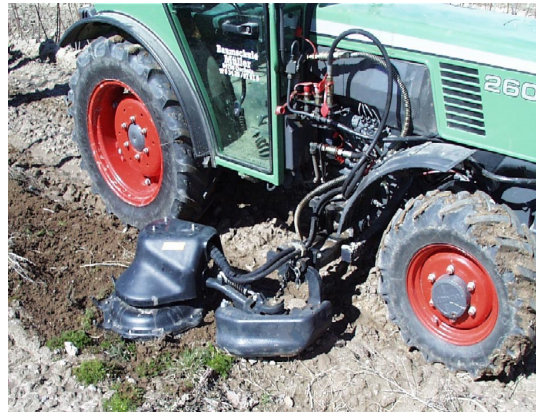
Abb. 5 (oben links): RADIUS NG im Zwischenachsanhbau mit Scheibenmulcher (Versuchsanbau)
