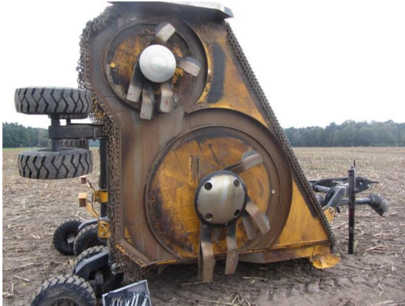
Vertikale Drehachse, 2 Schnittebenen (V)
