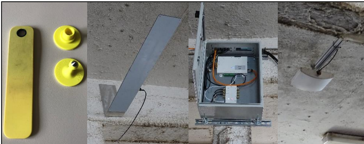
Abbildung 2: Abbildungen der Systemkomponenten Langohrmarke CattleData zur Tiererkennung, Futtertischantenne, POE-Box im Stallgang, Laufgangantenne
