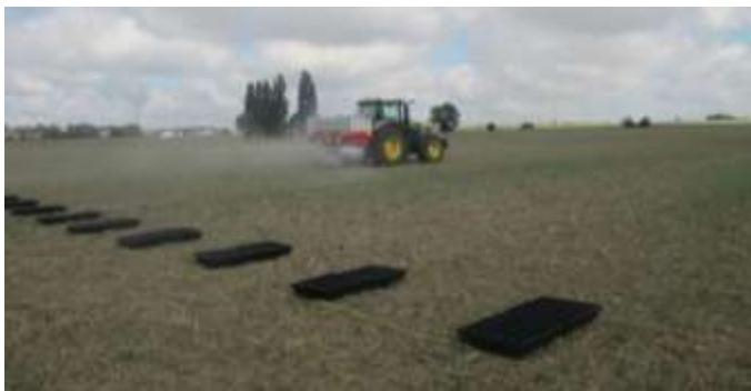
Abbildung 3: Optimierung der Querverteilung mit Prüfschalen im Feld. Foto: AgUmenda GmbH – Peter Müller, 2017
