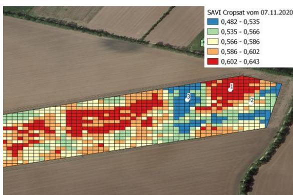
**Abbildung 1:** <sup>1</sup>Der MSAVI2-Index weist auf relative Unterschiede in der Herbstbiomasse hin (höherer Index bedeutet mehr Biomasse)
