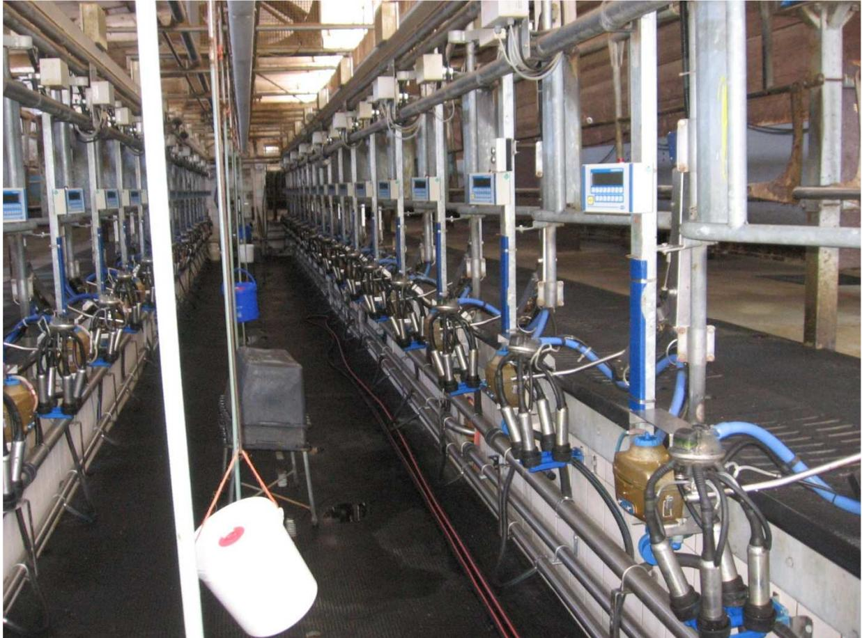
**Abbildung 2: Der 2 x 18 Fischgrätenmelkstand war die älteste Melkanlage in der Studie von 2010 - 12. Auf Grund der hohen Auslastung gestaltet sich der Unterhaltungsaufwand in Bezug auf die Leistung moderat.**
