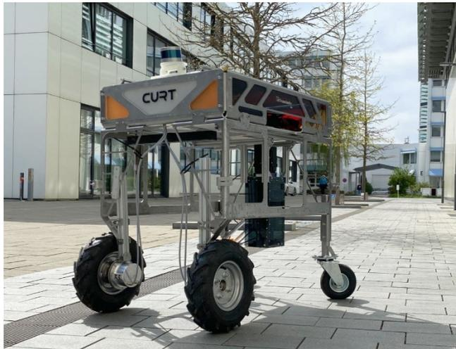
Feldroboter CURT mit Rocker-Kinematik (Bild: IPA)
