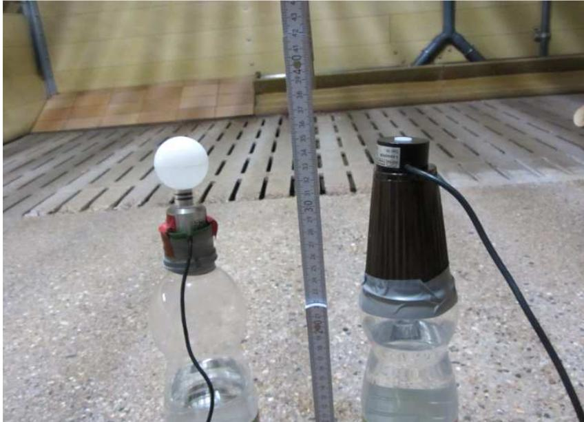
**Abbildung 3:** Messsensoren und Messaufbau in „Blickhöhe“ junger Schweine
