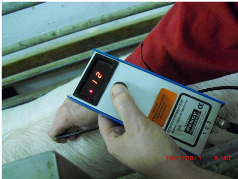
Abbildung 11: Speckdickenmessung mittels Leanmeater (Verstärkerstufe 3)
