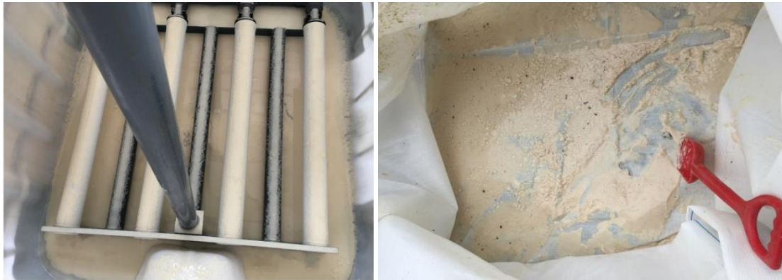
Abbildung 19. Hefeerntung durch Abschaben der Hefen nach Entnahme der Belüftungsanlage aus dem Big Bag.
