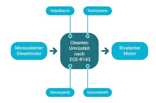
Herz des Umrüstsatzes ist ein Steuergerät, das mit (bio-)LNG, (bio-)CNG, LPG, H<sub>2</sub> und anderen alternativen Kraftstoffen arbeiten kann
