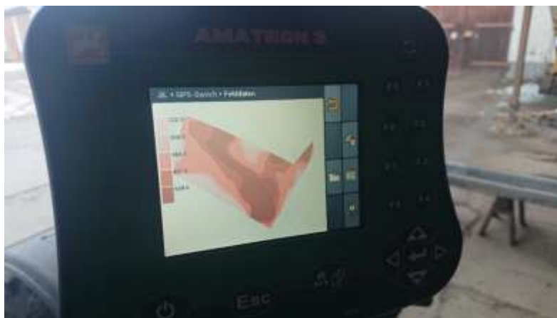
Abbildung 3: Applikationskarte auf dem Amatron 3 Terminal zum Streuen - Ware in kg/ha, Bild: Marc Büchner.
