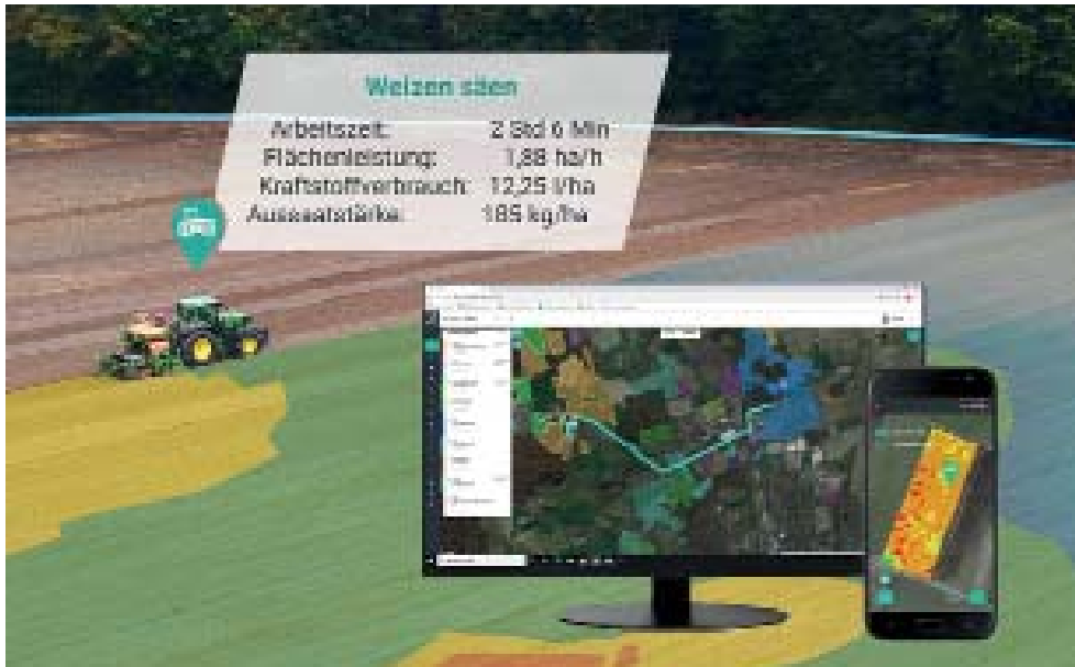
Maschinenmanagementsysteme dokumentieren unter anderem Arbeitszeit, Flächenleistung, Kraftstoffverbrauch und Aussaatstärke.
