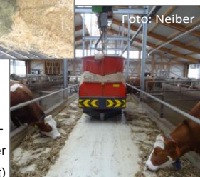
Futtermisch- und Verteilroboter (schienengeführt)
