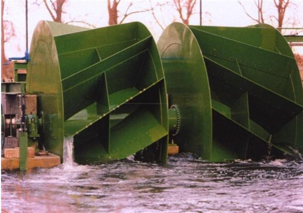
**Abb. 44:** Staudruckmaschine (Foto BRINNICH 2004)
