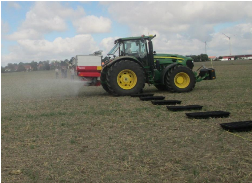
Abbildung: Überfahrt des Schleppers mit eingeschaltetem Streuer über den mobilen Prüfstand
