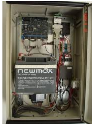
Datenlogger und Funkübertragung
