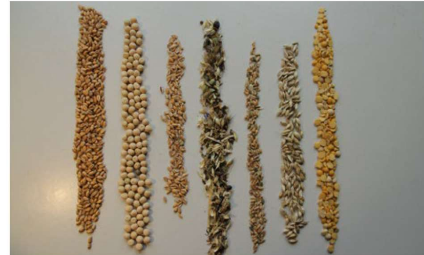
Besatzfraktionen einer Probe: v.l.n.r.: Weizen, Erbsen, Weizenbruch, Schwarzbesatz, Kornbesatz, Spelzen, Erbsenbruch. FOTO: G. SAATHOFF
