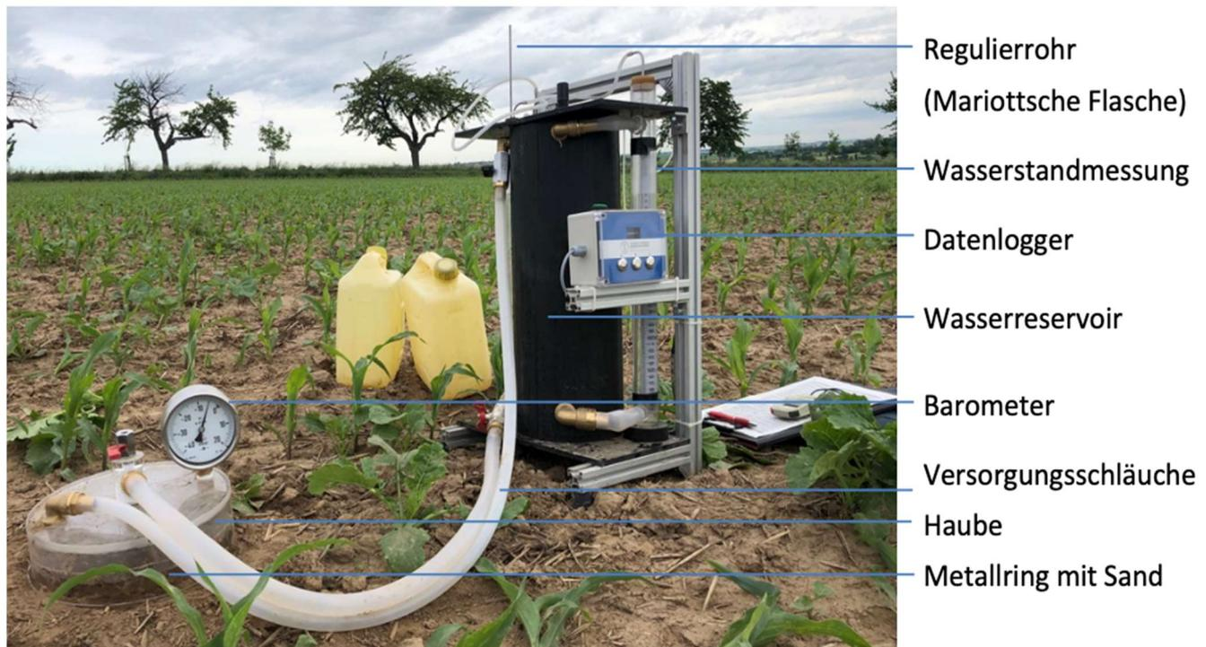
Gleichzeitig begünstigt ein hoher Wasserrückhalt in den tieferen Bodenschichten die Wasserumverteilung, weil feuchter Boden eine höhere Wasserleitfähigkeit besitzt. Mit Tensionsinfiltrometern lässt sich die Wasseraufnahme des Bodens gegen einen definierten Unterdruck messen. Damit werden natürliche Bedingungen von entstehenden Wasserfilmen und teilgesättigten Bodenzuständen simuliert, statt Wasser mit Überdruck in den Boden versickern zu lassen (Ringinfiltrometer). Wir
