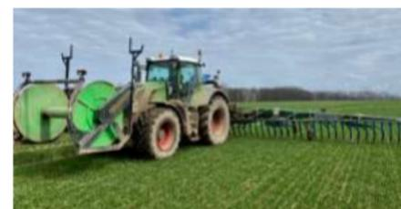
Abb. 1: Durch Gülleerschlauchung lässt sich die mechanische Belastung für den Boden erheblich reduzieren und somit die Ausbringzeit im Frühjahr deutlich erhöhen. (Quelle: LWB Kitzscher)
