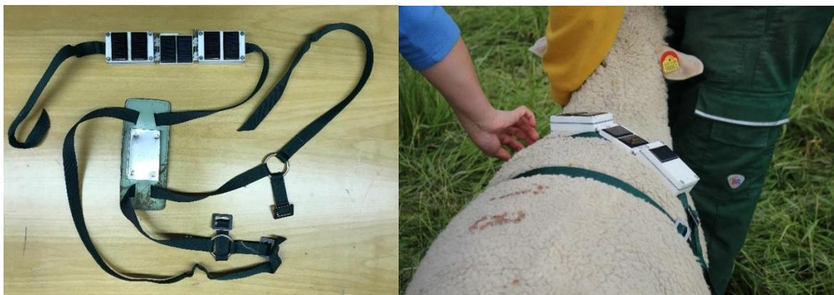
**Abb. 1: Auf Bocksprunggeschirr aufgebrachter GPS-Tracker, Anbringung am Tier**
