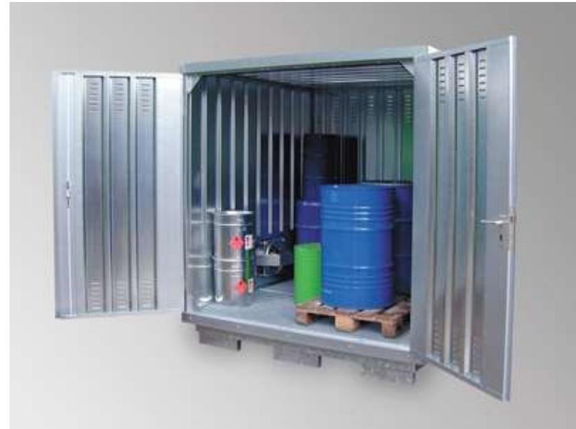
**Sicherheits-Lagerhaus für die Lagerung wassergefährdender Stoffe, zur Aufstellung in Gebäuden oder im Freien, auf ebenem und befestigten Grund, aus verzinktem Stahlblech, mit integrierter Auffangwanne und Gitterrostauflage als Boden**
