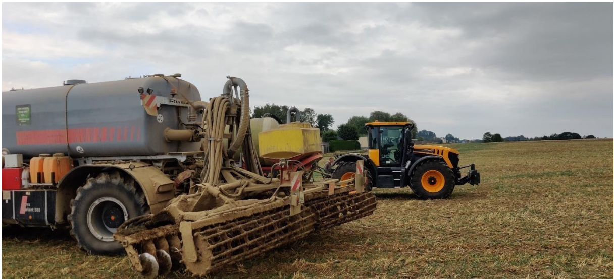
Abbildung 4: Holmer Selbstfahrer mit angehängter Scheibenegge und angebautem Saatguttank für die zeitgleiche Gärrestausbringung und Zwischenfruchtaussaat
