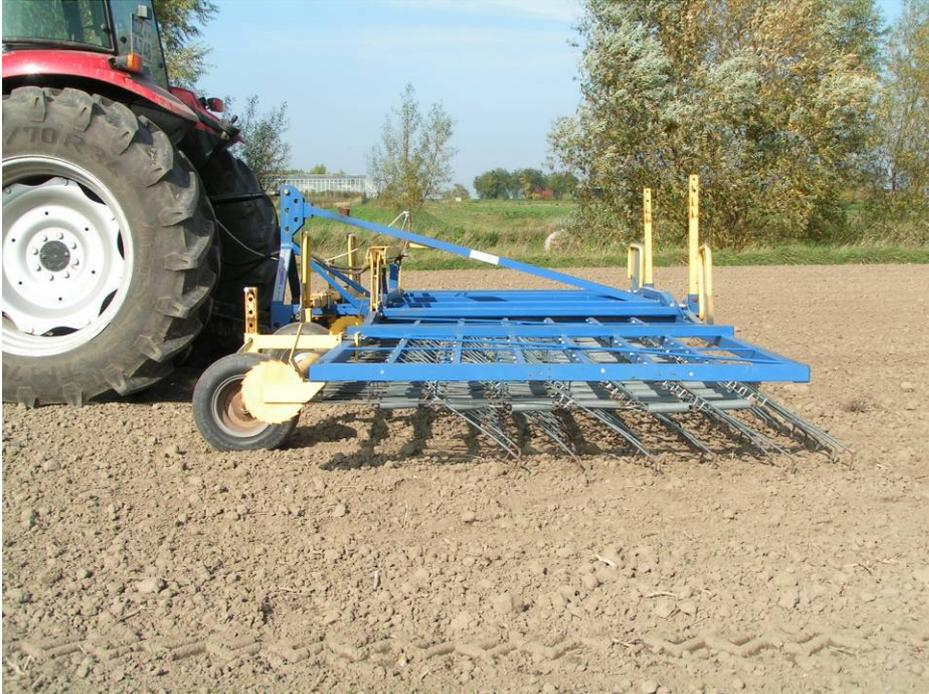
**Abbildung 7:** Grundeinstellung des Striegels: Rahmen waagrecht und Zinkenschäfte in einem Winkel von etwa 30° zur Bodenoberfläche, um eine umfangreiche Bodenangepassung zu gewährleisten. Bei diesem Striegeltyp mit indirekter Zinkenfederung ergibt sich der Zinkenstellwinkel aus dem Abstand des Rahmens über dem Boden.
