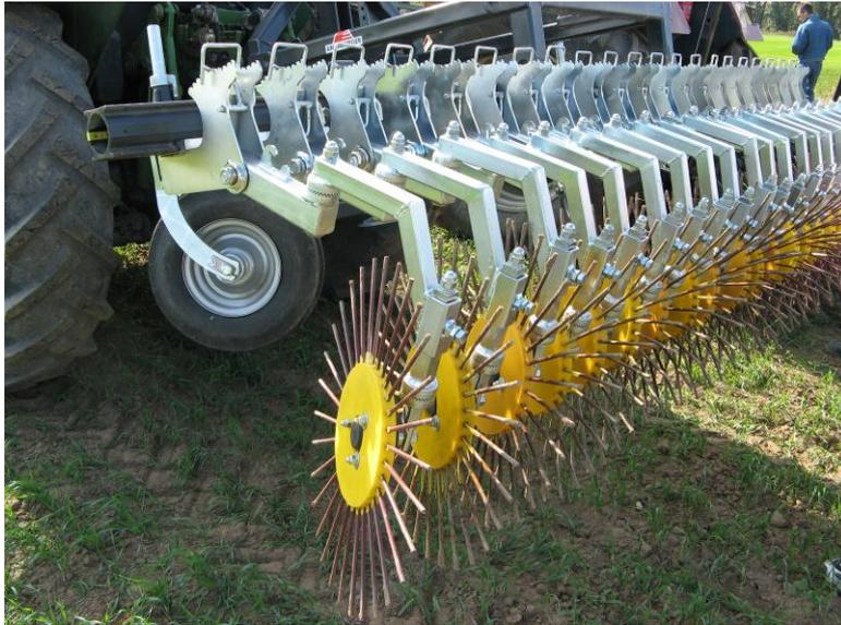
**Abbildung 15: Aufbau des „Turbo-Rollstriegels“ (Hersteller: Annaburger Nutzfahrzeug GmbH). Je zwei der sternförmigen Werkzeugträger bilden eine Einheit hinsichtlich der Boden Anpassung. Die Ebene der Zinken liegt schräg zur Fahrtrichtung, dabei arbeiten die Zinken nach dem Prinzip eines Striegels.**
