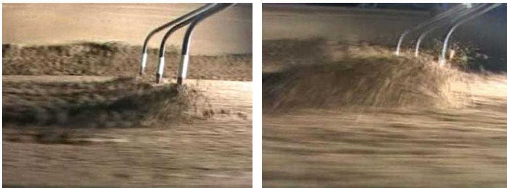
**Abbildung 6: Dynamikunterschiede in der Bewegung von Bodenpartikeln beim Striegeln mit 3 cm Arbeitstiefe bei den Geschwindigkeiten 4 km/h (links) und 8 km/h. Die weißen Markierungen am Striegelzinken entsprechen 2,5 cm Länge. Die Wurfhöhe verdoppelt sich in diesem Fall mit der höheren Geschwindigkeit.**
