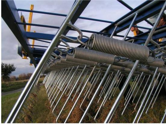
**Abbildung 3: Anhängungspunkte von Schraubenzugfedern in der Nähe des Drehpunktes von Striegelzinken zur Kompensation eines Teils der zunehmenden Federkraft bei der Zinkenauslenkung.**
