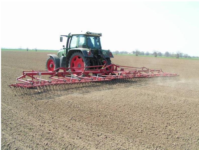
**Abbildung 1: Gute Voraussetzungen zum Striegeln: feiner, ebener, trockener Boden und sonniges Wetter.**
