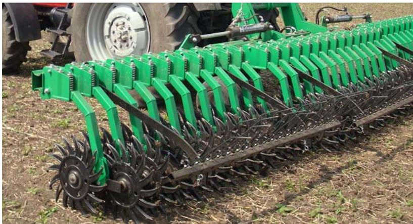
**Abbildung 16: Aufbau eines „Sternstriegels“ (Hersteller: Hatzenbichler). Die Zinkenelemente rotieren in der gleichen Ebene wie die Traktorräder. (Foto: Ch. Rogge)**
