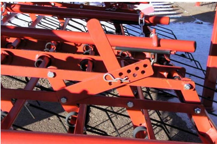
**Abbildung 8:** Einstellhebel für den Anstellwinkel der direkt gefederten Zinken mit fein abgestuftem Raster. Hier lässt sich die Arbeitstiefe justieren und der Arbeitswinkel des Zinkens grundlegend vorwählen. (Foto: U. Becherer)
