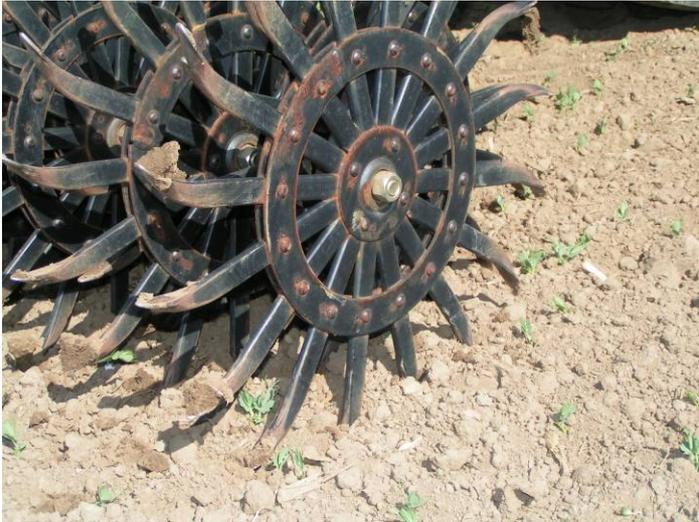
**Abbildung 17:** Die Zinken der „Rotary Hoe“ (Hersteller: Yetter Farm Equipment) oder des Sternstriegels stechen nacheinander in den Boden ein und hebeln beim Austritt aus dem Boden ein geringes Bodenvolumen aus. Das ausgestochene Material fällt bei der weiteren Rotation der Werkzeugelemente zurück auf den Boden. Trotz relativ dichter Werkzeuganordnung wird in der Regel keine vollflächige Bodenbearbeitung mit einem Arbeitsgang erreicht.
