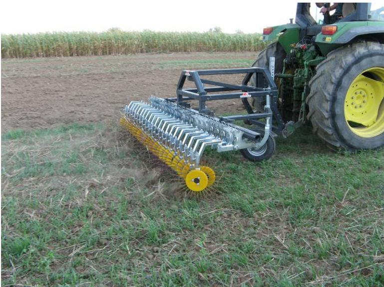
**Abbildung 18:** Der Rollstriegel neigt ähnlich wie die Rotary Hoe oder der Sternstriegel in Mulchsaaten nicht zu einem Mitschleppen von Getreidestoppeln oder anderem Mulchmaterial und eignet sich daher für den Einsatz in Mulchsaaten.
