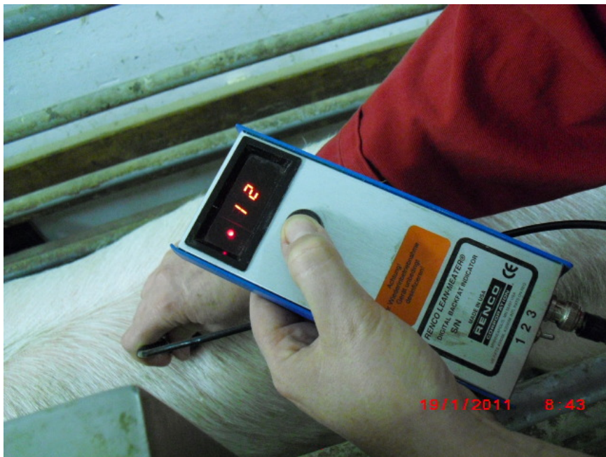
Abbildung 21: Speckdickenmessung mittels Leanmeater (Verstärkerstufe 3)
