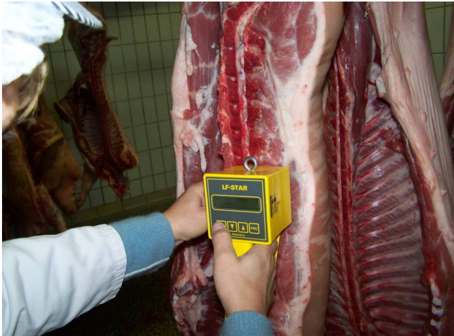
Abbildung 17: Messung der Leitfähigkeit
