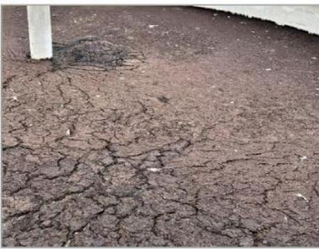
trockene Schwimmschicht, nur oberflächliche Risse Dicke 10-20 cm
