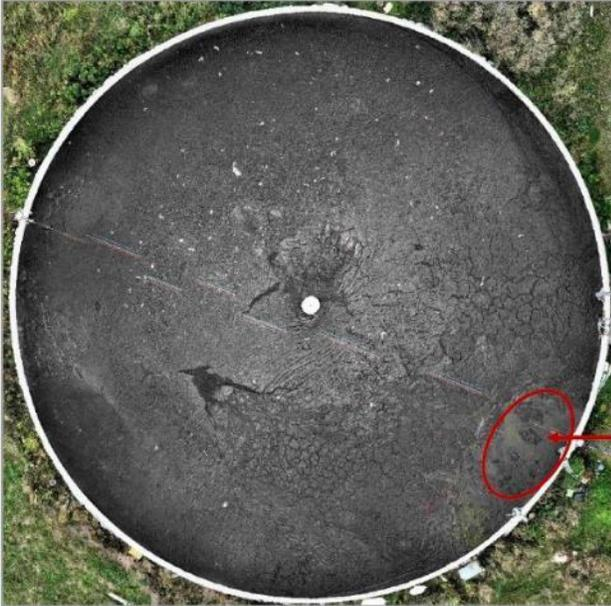
überwiegend geschlossene trockene Schwimmschicht, Dicke 10-20 cm
