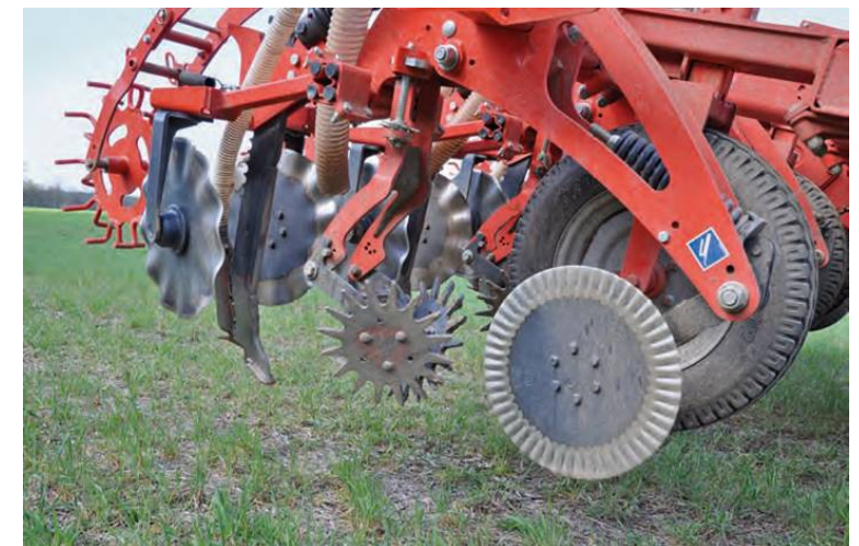
Quelle: Werkzeugführung Kuhn Striger zur Streifenbearbeitung)
